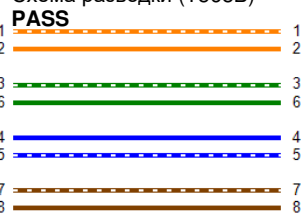
Схема разводки (T568B)
